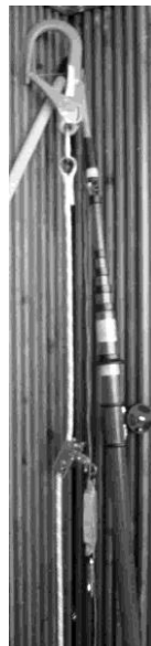
22.-23. Vezető kötélnél zuhanás-gátlóval, kezelőrúddal
