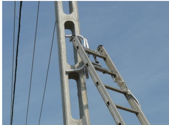
87. A létra felső részére szerelt támasztó szerkezet
